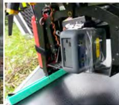
回転翼UAV, 線量計やカメラを搭載
