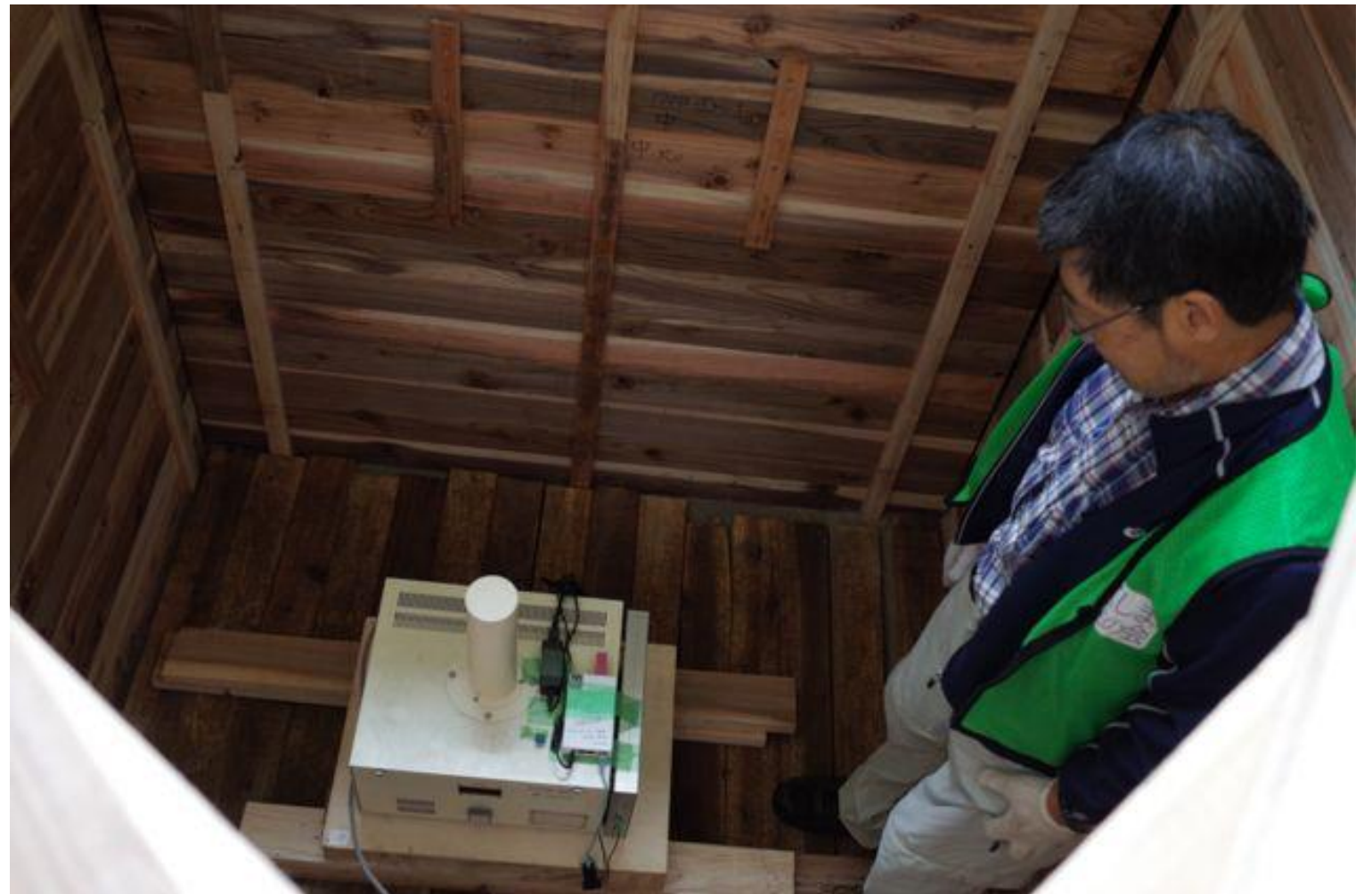
周囲の影響がほとんどない、コンクリート製のサイロ内にて杉板材からの放射線を測定
