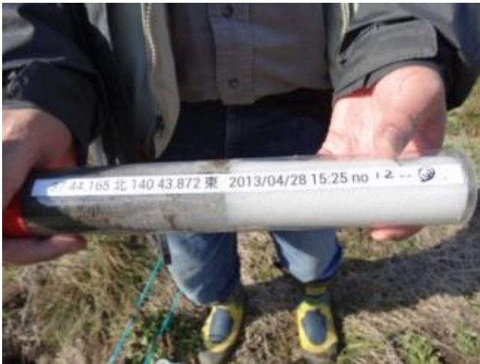
ライナー(透明の筒)に採取された 土壌のサンプル
