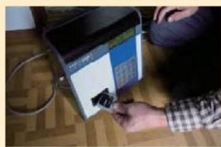
DIS-1 を専用の読み取り装置に挿入する
