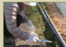
③採取後、ビニール袋または直接20mlの測定容器に詰める。
