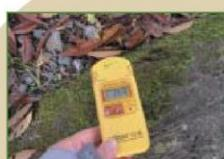
①採取するサンプルの上、地上10cmの放射線量を測定
