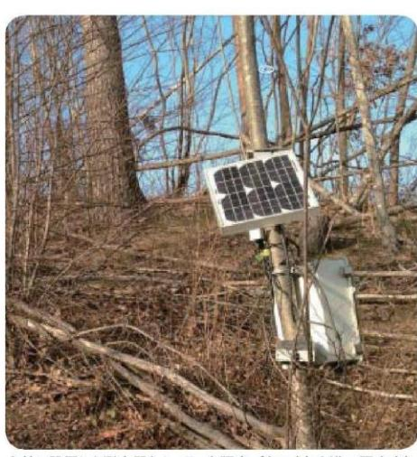
山林に設置した測定器とカメラ、太陽光パネル(東大溝口研究室)
