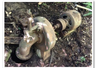
タービンと発電機
