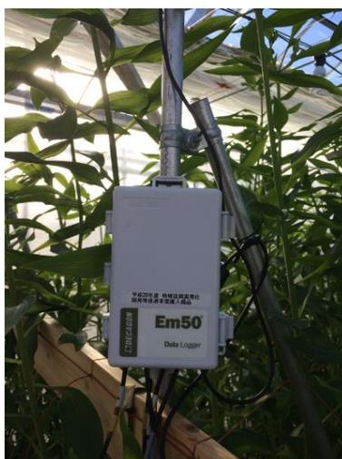
図 10 各種データを記録するデータロガー（このこれに記録されたデータがインターネット経由でクラウドサーバに自動送信される）
