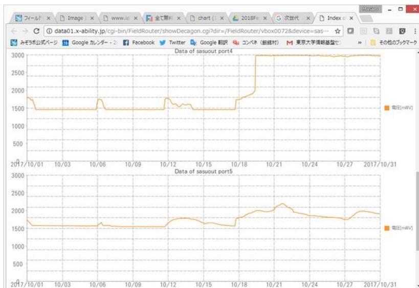
図 2 水田の水口に設置された水位計と濁度計によって測定された田面水の水位変化と農業用水の濁度の変化 (1 時間ごとのデータがクラウドサーバに自動送信される)
