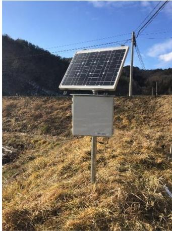
図4 フィールドでWiFiを使えるようにするためのリピータシステム。
